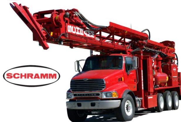
Schramm 94 килофунтов (с цепной передачей 750 л.с.), одиночн.
